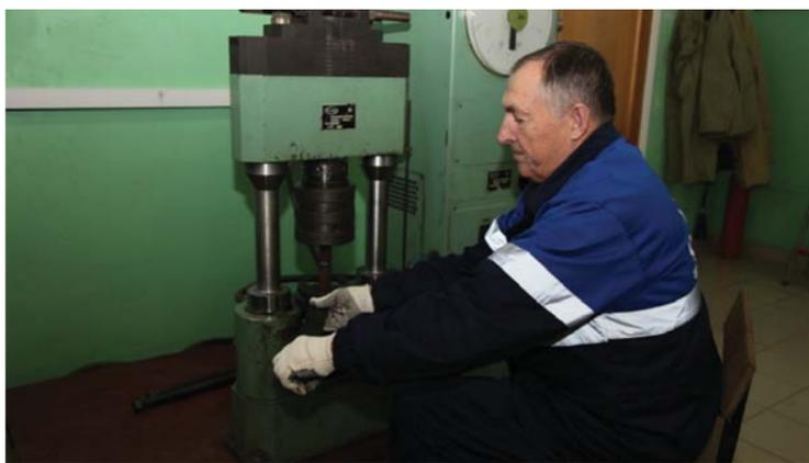
*Евгений Ранчин проводит механические испытания сварных стыков стального газопровода*
