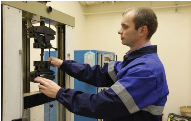
*Павел Илясов проводит механические испытания сварных стыков полиэтиленовых газопроводов*
