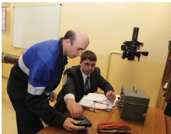
Евгений Махлаков (филиал ОАО «Газпром газораспределение Тамбов» в г. Уварово) измеряет переходное сопротивление изоляции трубопровода
