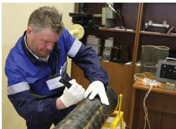
Дмитрий Сазыкин (филиал ОАО «Газпром газораспределение Тамбов» в п. Коммунар) проверяет адгезию изоляции стального трубопровода
