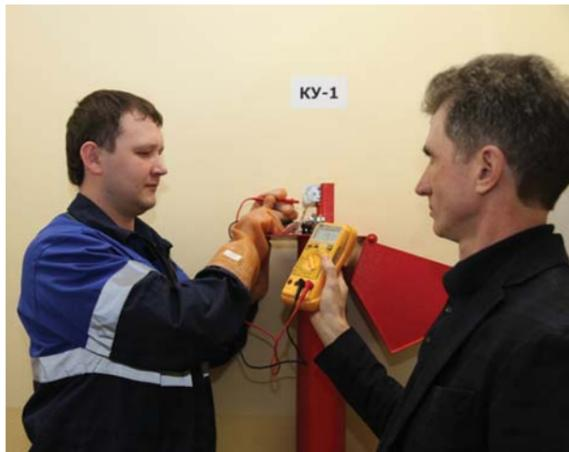
Сергей Сидоркин (ОАО «Газпром газораспределение Тамбов») проводит измерение защитного потенциала на газопроводе
