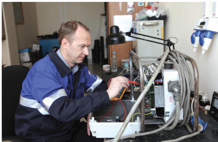
Андрей Титов ремонтирует плату управления муфтового сварочного аппарата АМ-65
