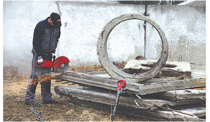
Демонстрация работы пилы дисковой ПДГ300, для резки металла, армированного бетона, асфальта
