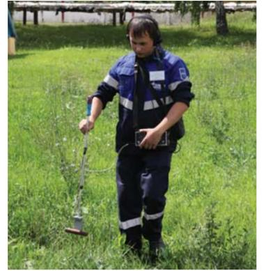
Сергей Ефремов успешно выполняет задания – определение трассы подземного газопровода
